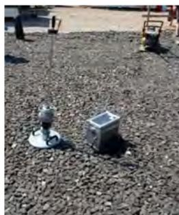
Durchführung von Lastplattenversuchen mit der entsprechenden Auswertung.
