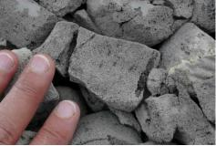
Beim dritten Versuch mit Charge 57 wurde ohne eine Randbegrenzung die Verdichtungsleistung der Anbauplatte getestet. Auf der Schütthöhe von 40 cm erreichte der Anbauverdichter mit 70 KN Schlagkraft eine Verdichtung von 1,6: 1 (40 auf 25 cm) nach ca. 9 sek. Das Material besaß mit einem EVd von über 53 MN/m² eine enorme Steifigkeit.
