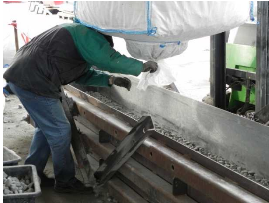
Abbildung 3-81: Einfüllen von Glasschaumgranulat in den Versuchsbehälter
