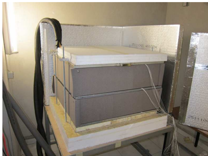
Abbildung 4-16: Modifizierte 2-Platten Apparatur zur Aufnahme von Schaumglas-Granulat-Schüttungen
