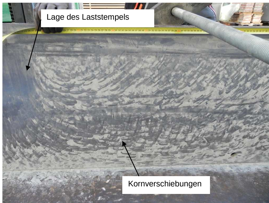
Abbildung 3-105: Darstellung der Kornverschiebungen durch Kornabrieb von der Probe an der Seitenwand des Versuchsbehälters
