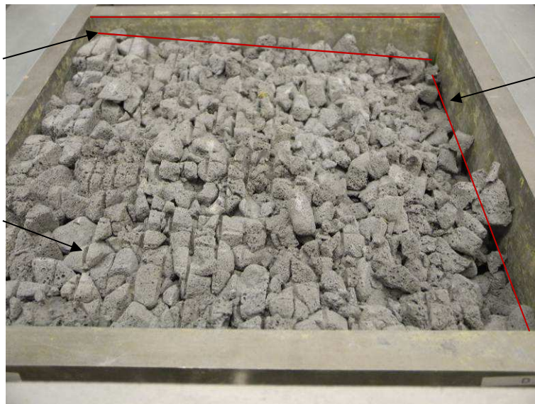
Abbildung 3-68: Darstellung des Kippens der Platte für die Lasteinleitung (oben); Oberfläche der Probe nach dem Scherversuch mit einer Normalspannung von \sigma = 100 \text{ kN/m}^2 (unten)
