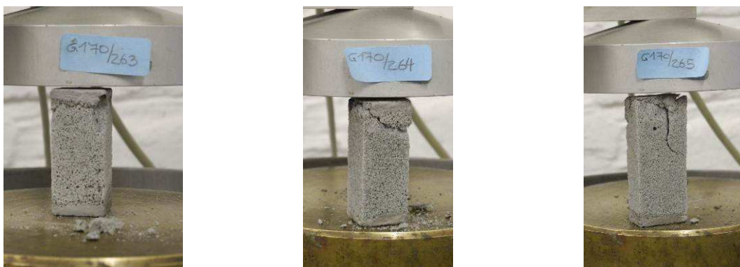
Abbildung 3-23: Beschichtete Prismen nach durchgeführten Druckversuch
