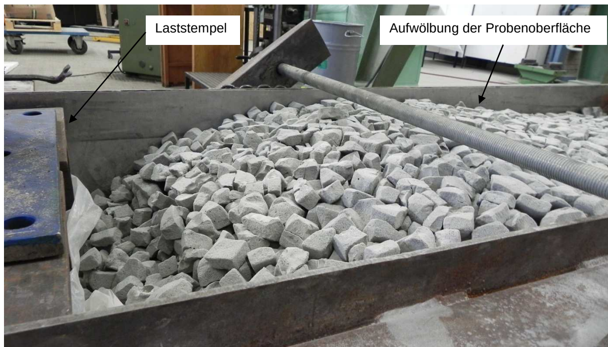
Abbildung 3-104: Aufwölbung der Oberfläche der Probe seitlich des Laststempels während des Versuchs
