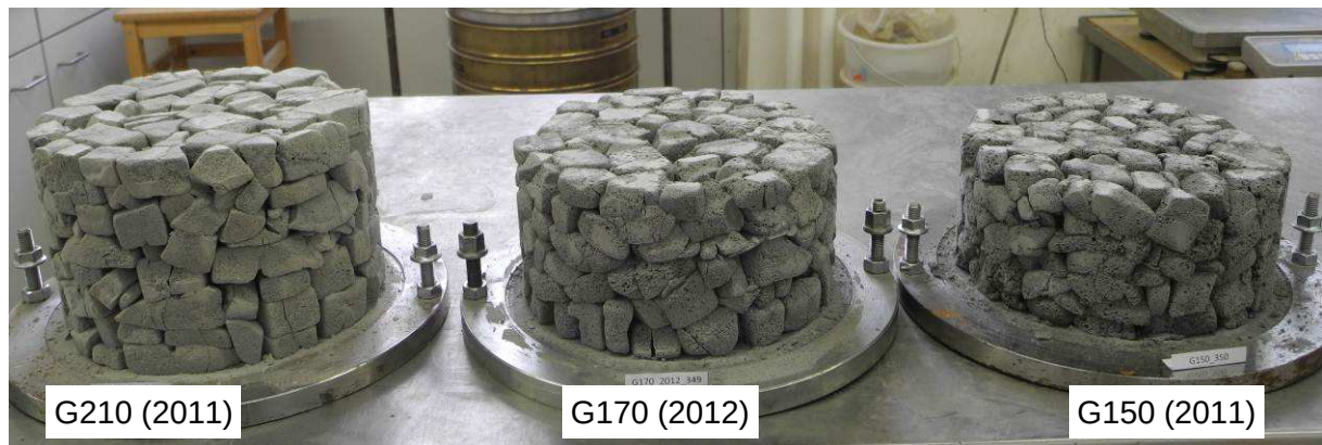
Abbildung 3-79: Proben nach der Beanspruchung – Verzahnung der Körner
