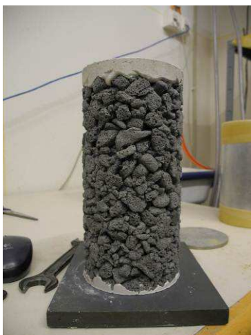
Abbildung 3-71: Probekörper für die Triaxialversuche (links), Probe mit übergestülpter Gummimembran (rechts)
