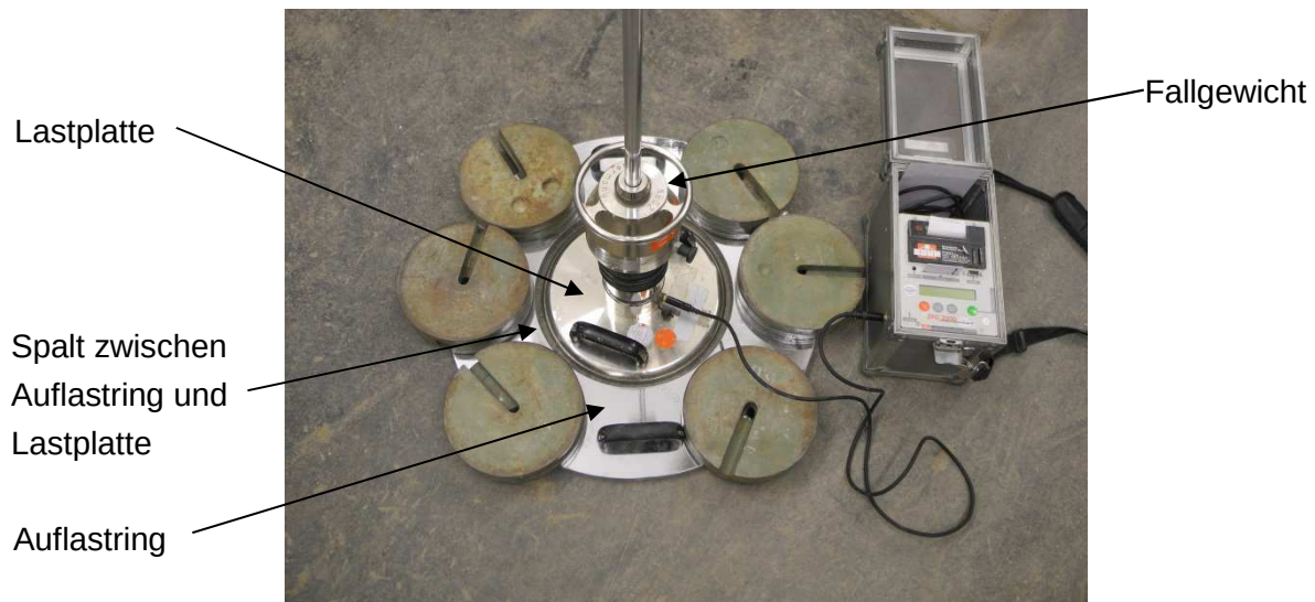
Abbildung 3-116: Auflastring rund um die Lastplatte
