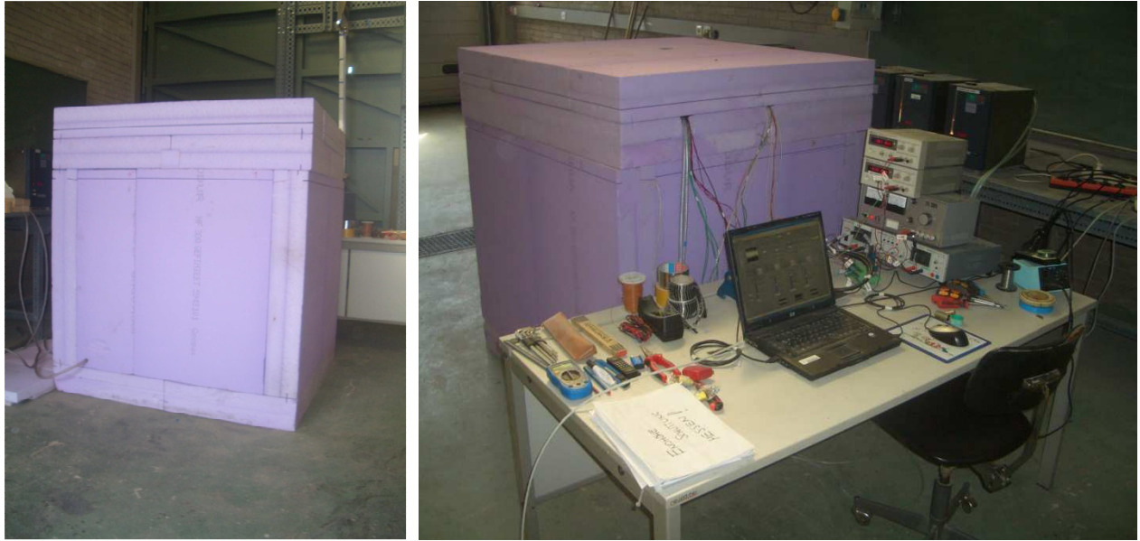
Abbildung 4-9: Fotos der Apparatur in gedämmtem Zustand
