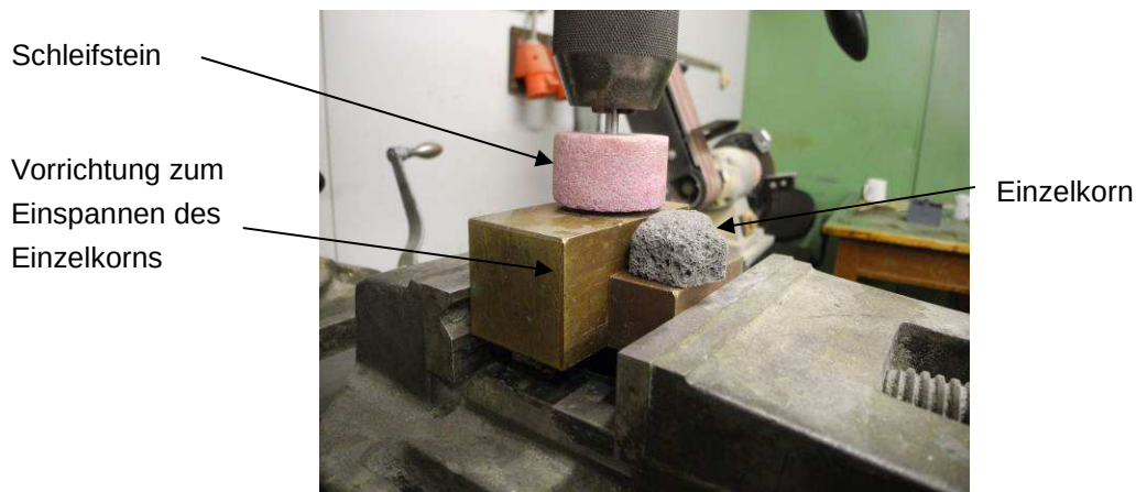
Abbildung 3-3: Vorrichtung zur Herstellung von Glasschaumprismen
