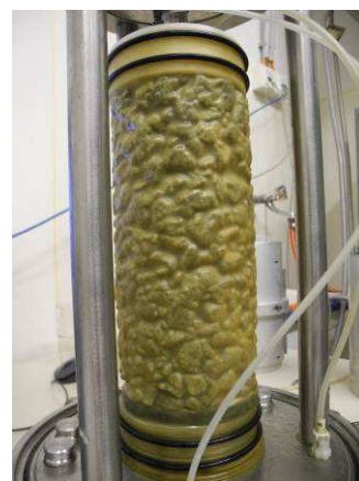
Abbildung 3-71: Probekörper für die Triaxialversuche (links), Probe mit übergestülpter Gummimembran (rechts)
