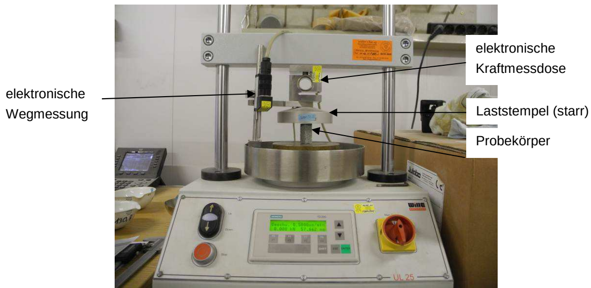
Abbildung 3-4: Elektromechanische Presse zur Durchführung der einaxialen Druckversuche
